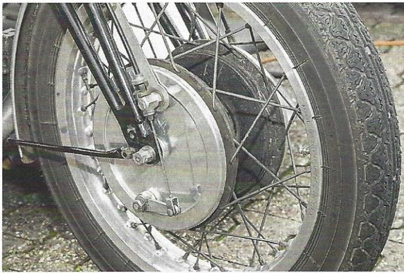
Zwei gegeneinander verschraubte Halbhubbremsen mit selbst gefrästen Ankerplatten verzögern das Vorderrad
